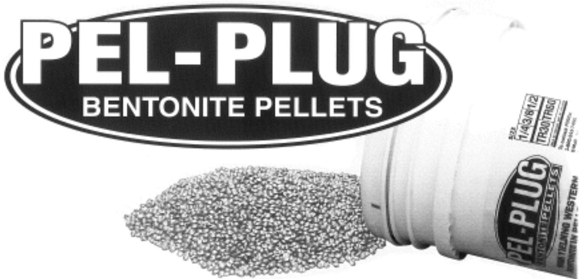
ペルプラグは良質のアメリカ産ベントナイトを圧縮し、粒状(ペレット状)にしたものです。ペルプラグは、膨潤度が高く、止水力に優れており、直接掘削孔へ投入するだけで、止水剤及び逸泥防止剤として優れた効果を発揮します。
